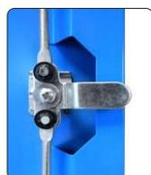
① **Fermeture 3 points :** elle est composée d'une serrure à came multipoints et d'un système à tringles. En verrouillant la fermeture, elle actionne les 3 points de condamnation de la porte (haut, milieu et bas), offrant ainsi une sécurité maximale. (montage en usine uniquement)
