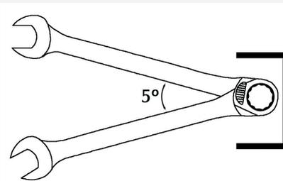
**Polyvalence: permet de serrer de multiples et différentes têtes de vissage, telles que sphérique, 6-pans, 12 pans, E-torx et carrés, y compris des têtes arrondies à 50% par usure.**
