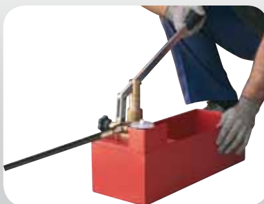
3- Pomper jusqu'à atteindre la pression
