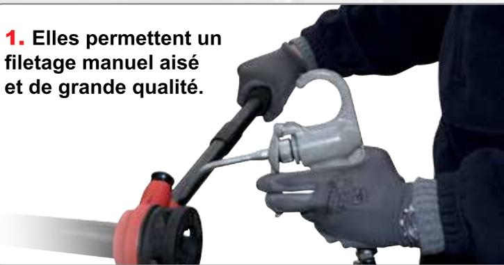
**2.** Le collet est plus long que la tête, ce qui permet un meilleur positionnement, ce qui réduit les vibrations, ce qui permet une qualité de filetage et une extraction du cliquet.
