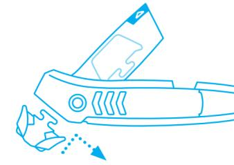
Positionnez la lame de rechange **parallèlement** à la partie inférieure du manche et insérez-la. Couissez ensuite la tête de lame **vers la droite** jusqu'à la butée.
