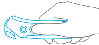
Pour une prise en main optimale, placez votre pouce sur la **surface rainurée**. Le soft-grip offre encore plus de résistance au glissement.
