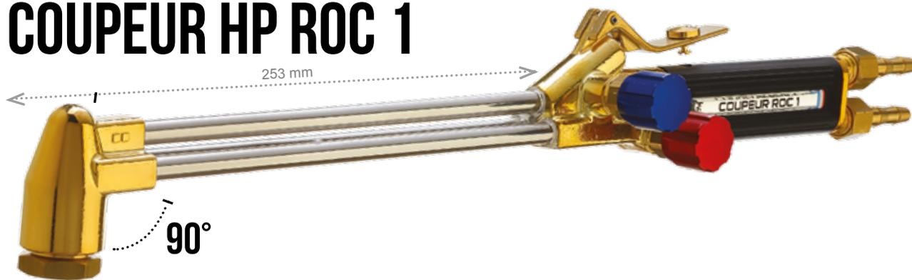
Le chalumeau COUPEUR HP ROC 1 est de même conception que le COUPEUR HP MINI ROC avec une capacité de coupe supérieure (300mm). L'apport de l'oxygène de coupe se fait par pression sur la gâchette ou bien par un robinet de coupe actionné par un volant selon les modèles. Possibilité de tubes de longueurs différentes (de 500 à 1000 mm) ainsi que des angles de têtes allant de 90, 135 à 180°.
